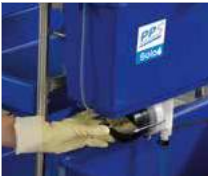
1 Einstellen der benötigten Flüssigkeitsmenge (150 – 300 ml)
