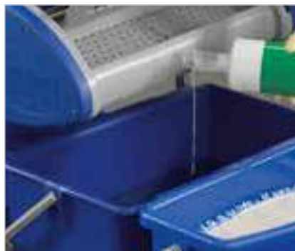
2 Reinigungslösung im 25 L Eimer ansetzen; bitte beachten Sie die Anwendungsvorgaben des entsprechenden Chemieherstellers
