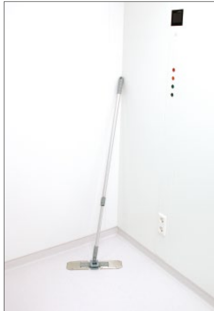
Abb. 3: Mopphalter lehnt ungesichert im Reinraum in einer Ecke und hat Bodenkontakt, welcher streng vermieden werden sollte
